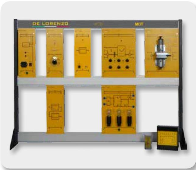
Questo laboratorio è stato progettato per introdurre gli studenti ai principi fondamentali della tecnologia della regolazione automatica. Le funzioni principali dei processi, dei controllori e dei sistemi controllati, così come le interazioni tra gli elementi di trasferimento degli anelli di retroazione, vengono dimostrate con l'ausilio della simulazione di un sistema controllato.
