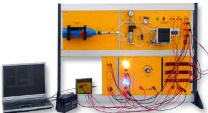
Sistema per lo studio delle celle di combustibile a idrogeno
