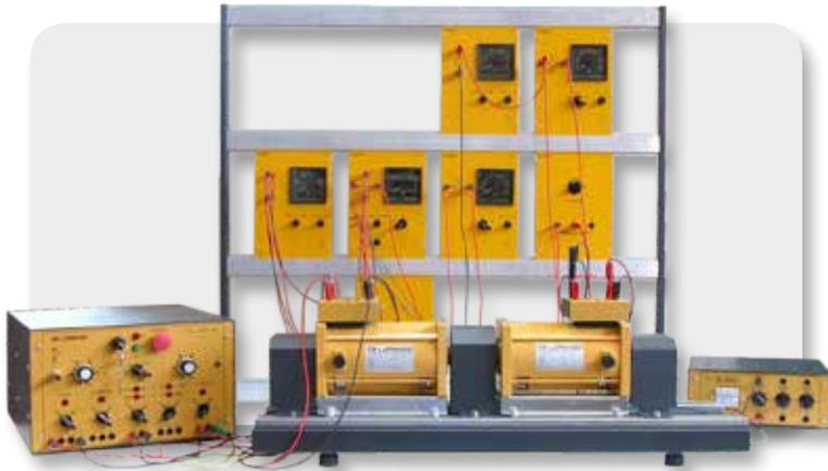
Il laboratorio per lo studio delle misure elettriche è composto da una serie di strumenti e componenti reali montati su pannelli isolati, i quali, a loro volta, possono essere assemblati su un telaio di lavoro per permettere di eseguire i collegamenti elettrici e di realizzare le esperienze proposte nel manuale didattico in modo semplice ed efficace dal punto di vista dell'apprendimento.
