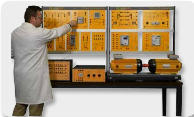
Il laboratorio di impianti elettrici affronta in modo completo e sistematico il tema del ciclo dell'energia elettrica, dalla sua generazione alla sua trasmissione e distribuzione su linee ad alta tensione, con relativi sistemi di protezione, fino al suo utilizzo da parte degli utenti finali.
