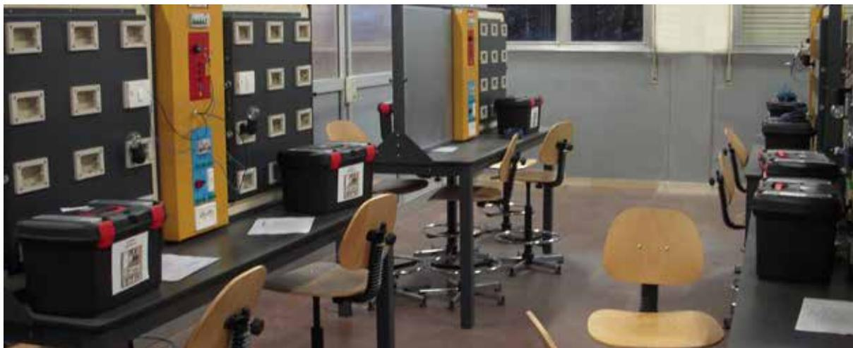
Progettati per permettere la realizzazione di esercitazioni di cablaggio nel settore delle installazioni civili ed industriali, offrono la massima versatilità di lavoro nel laboratorio. Grazie al sistema di aggancio rapido dei pannelli sui quali l'allievo esegue il circuito, si potranno così immagazzinare tutti i lavori non completati in una unica lezione lasciando così libero il telaio per altri allievi.
