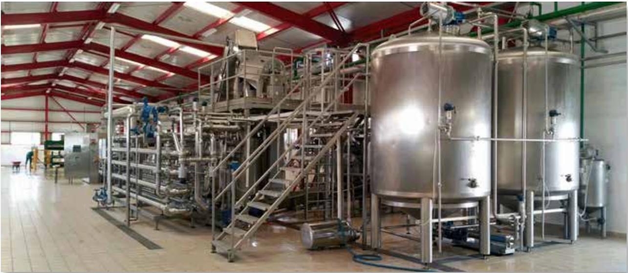
Il laboratorio permette lo studio delle tecnologie utilizzate per la lavorazione di frutta, verdura e latte, sia in modalità manuale che automatica con PLC, e consiste di singole macchine o di impianti completi destinati a piccole realtà produttive e a centri di formazione di Università e Scuole.
